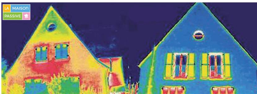
Image d'une thermographie : avant rénovation (à gauche) et après rénovation passive (à droite). Les couleurs chaudes représentent les déperditions d'énergie. Elles ont été largement supprimées après rénovation.
