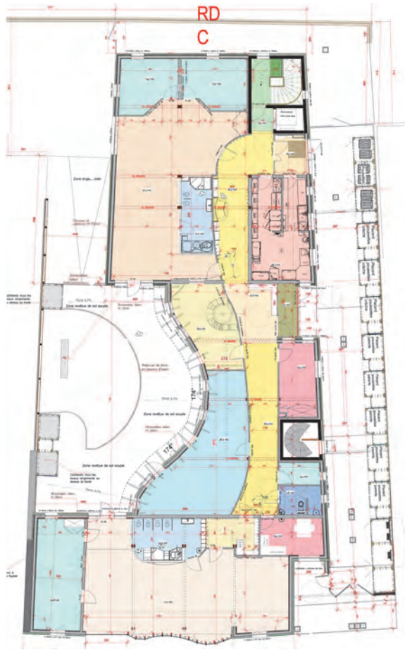
Plan du rez-de-chaussée (source : Altana Architectures)
