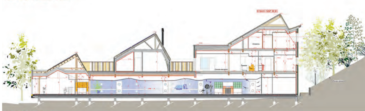
Coupe du bâtiment soulignant la surélévation de 1 m avec des micropieux pour intégrer le risque d'inondation
